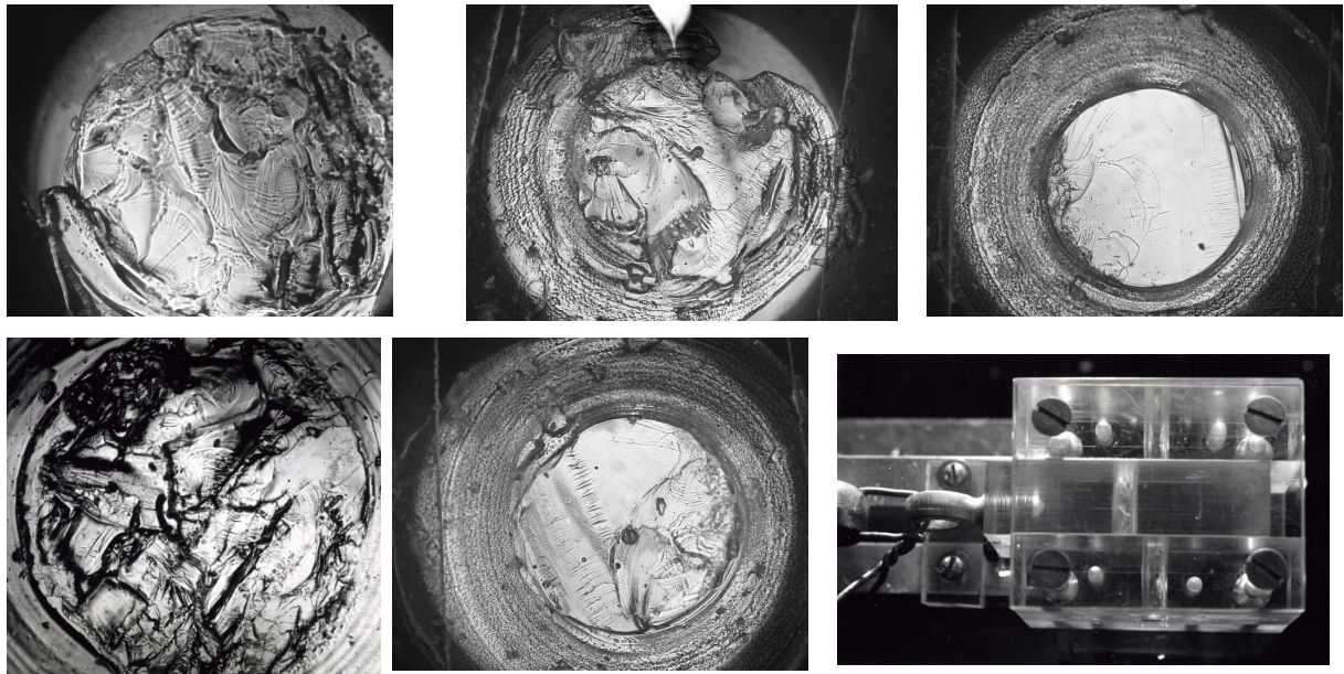
図 3.42 氷の剪断破壊面(対馬・藤井俊茂, 低温科学)
