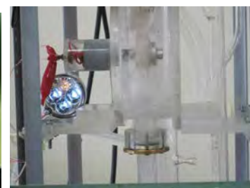
ダムから落下する液体流でター ビンを回し発電された自転車 用の発電機を回し点灯した
