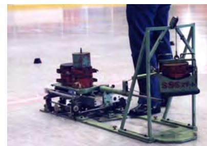
図 3.52 氷溜リンク(0001)面上のテストスケートの滑り
