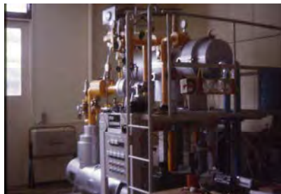
秋田大学で開発された雪を冷熱源とする温度差発電装置 右はフロン・タービンと発電機
