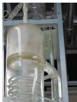
上端天井に噴射して気液が分離 される液体成分は内壁を伝って ダムへ落ちる。ガス成分は隙間を 抜けて下部冷却管に達する
