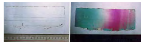
ベース氷に貼り付けた氷箭氷の上に 散水が厚さ 37mm となった。 3 層の横線は気泡や着霜面、単結晶 成長の妨げとはなっていない
