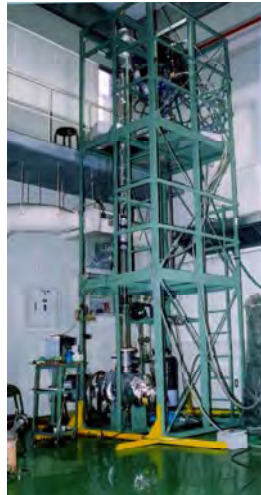
上：高さ5mの熱サイホン発電装置 気化熱の小さい20cal/g フロリナートが使われた 左：落差15mの熱サイホン発電装置
