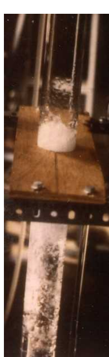
①激しく沸騰する媒体 主に蒸気流輸送
