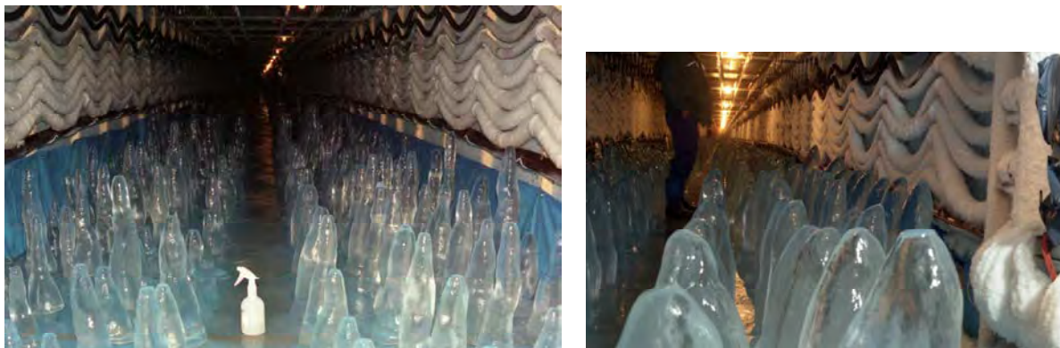
図 5.18 単結晶氷筈の大量人工育成(長さ 200m の氷筈育成室)
