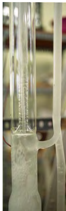
③細管部内に液噴射管 液噴射気液混相流
