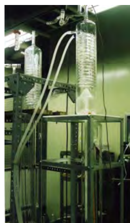
細い上昇管を上った混相流が膨張缶 下部の傘に衝突して気・液分離される
